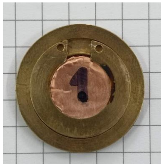
Նկար 5. Նիկել պղնձե բազմաշերտ թիրախ:
