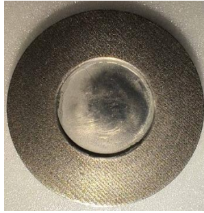
Նկար 2. 100 մգ զանգվածով մամլված ցինկի փոշին նիոբիումե թիրախակալի վրա:
